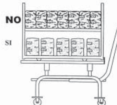
Paquetes colocados de manera muy apretada (arriba). Remoción del aire, contacto con el esterilizante y el secado será más eficiente (abajo).
